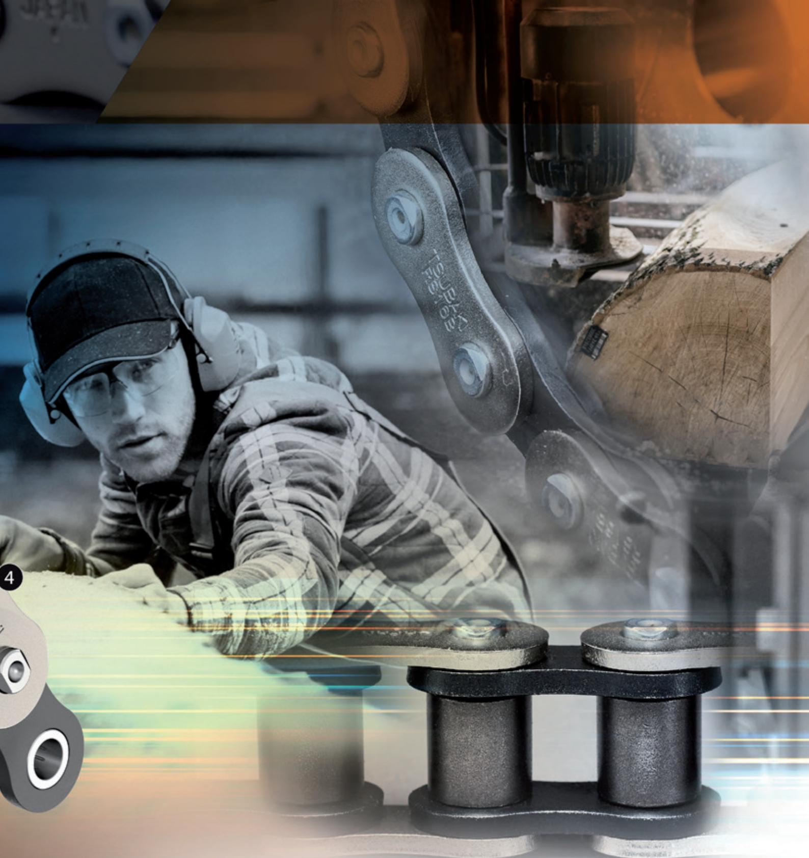
A seleção da corrente certa para o trabalho a ser feito costuma ser subestimada para o trabalho a executar. As condições extremas em que a poeira / partículas abrasivas penetram nas peças móveis reduzem significativamente a vida útil de uma corrente padrão. Isso se traduz num alto custo causado por tempo de inatividade, produção perdida, reposição de peças e mão de obra.
